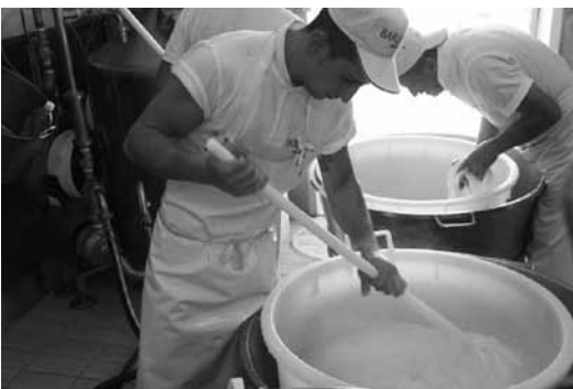
写真6 パスタ・フィラータ (Pasta Filata: 繊維状の生地) にする
