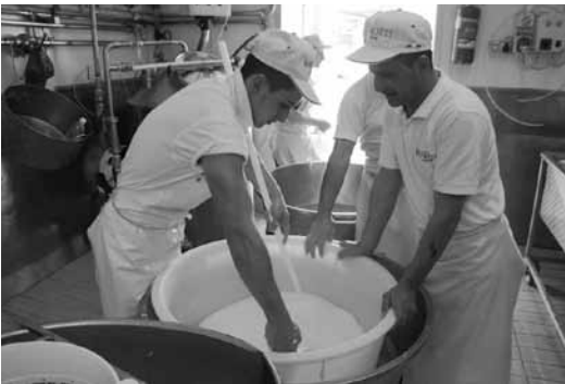
写真5 凝乳 (カード) に熱湯を注ぐ
